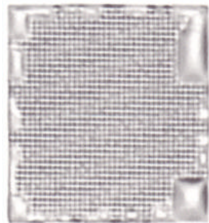
Abb. 17 Lichtoptische Abbildung eines Bereiches mit Strukturen der Größe 1 \times 1 \mu\text{m}^2 in einem belichteten und entwickelten Resist vom Typ (b).
